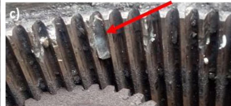
Quebra de engrenagem e engasgamento na coroa
