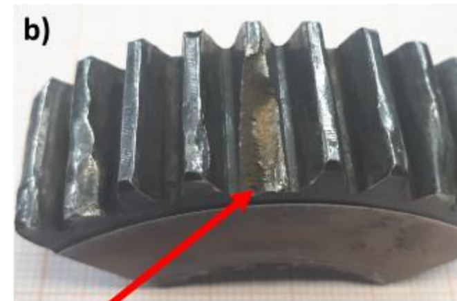
Quebra de engrenagem e engasgamento na coroa
