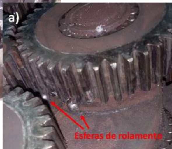
Quebra de engrenagem e engasgamento na coroa
